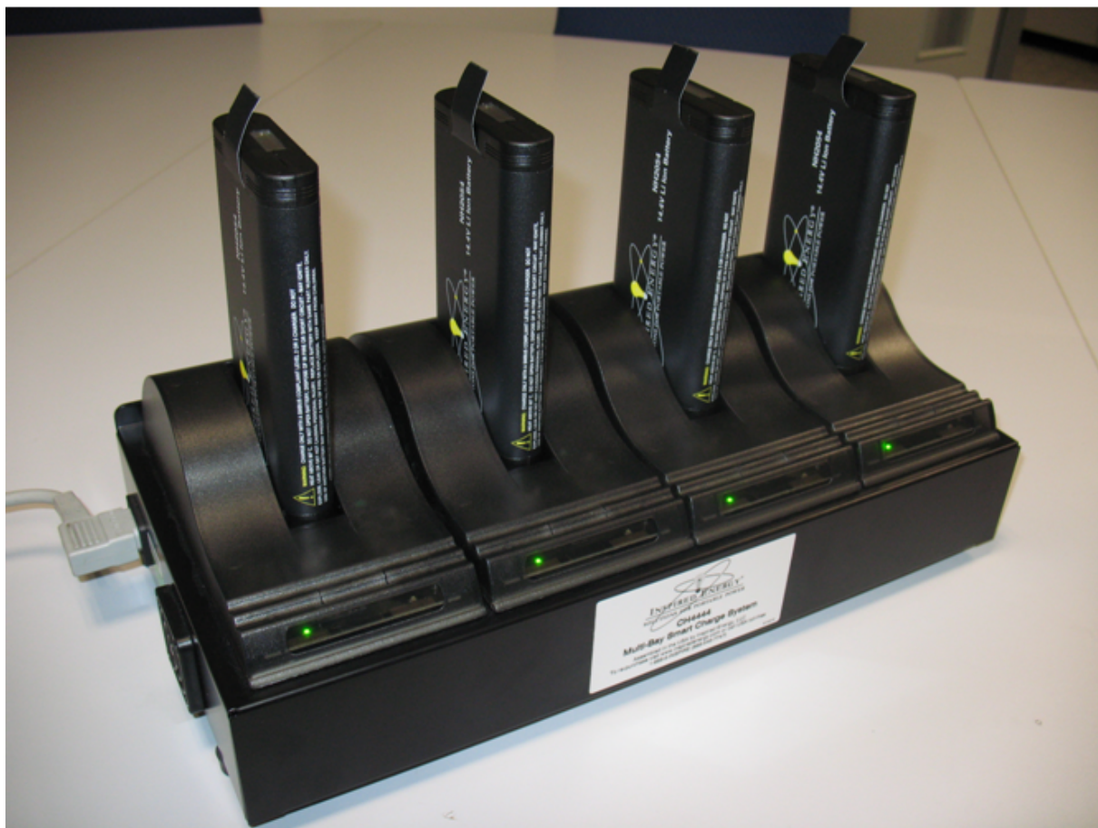
Fig. 3-2: Caricabatteria R&S FSV-B34
